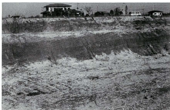
図4：小糸造成地の軽石層 S 55. 1. 2撮影 上からP・Q・R・S・Uの軽石層 手前の白いつぶは洗い出された軽石
