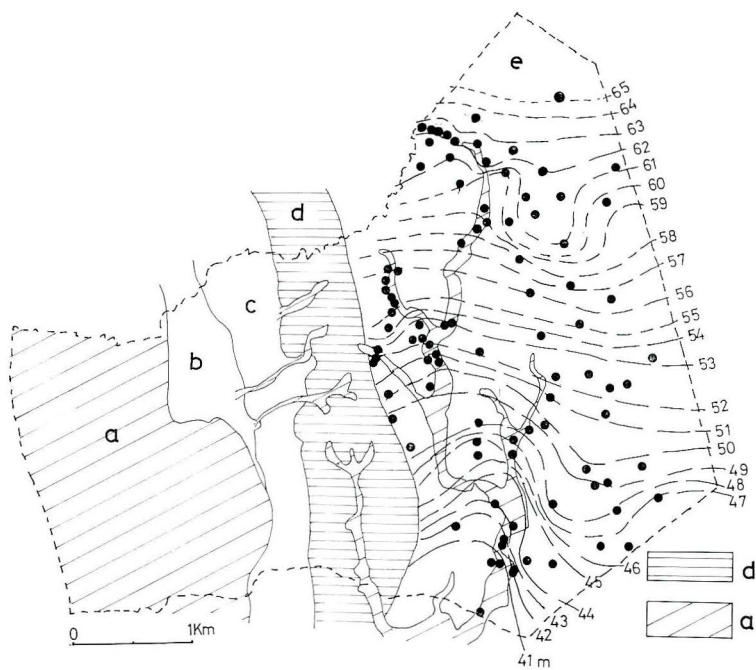
図2 相模野礫層頂面の等高線図(数値は海拔m), 市境は今永(1984)を参考に描く。 a:沖積低地, b:陽原段丘, c:中津原段丘, d座間丘陵, e相模原段丘
