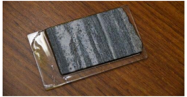
薄片プレパラートを作るために貼られた岩石切片
