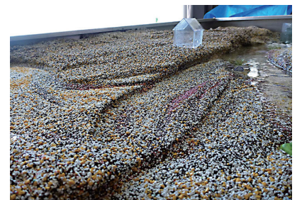
図3 海面の高さ(海水準)を変動させ、実験で作った河岸段丘。
