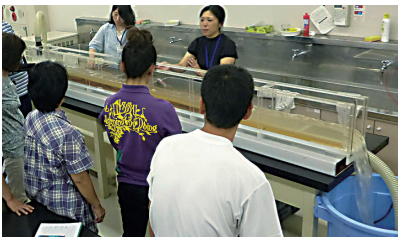
図1 アクリル製の堆積実験水路。左から右へと水を流す、一方向流の実験中。
