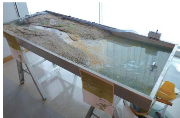
図 10. 河川地形流水実験（リトルリバーリサーチ&デザイン社製「エムリバー・ジオモデル Em2」）。 Fig. 10. Experiment of running water and geography.
