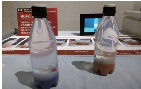
図 8. 地盤の液状化現象が観察できる実験装置（製作：石浜佐栄子）。装置の詳細は笠間ほか（2015）参照。 Fig. 8. Hands-on experiment equipment of liquefaction.
