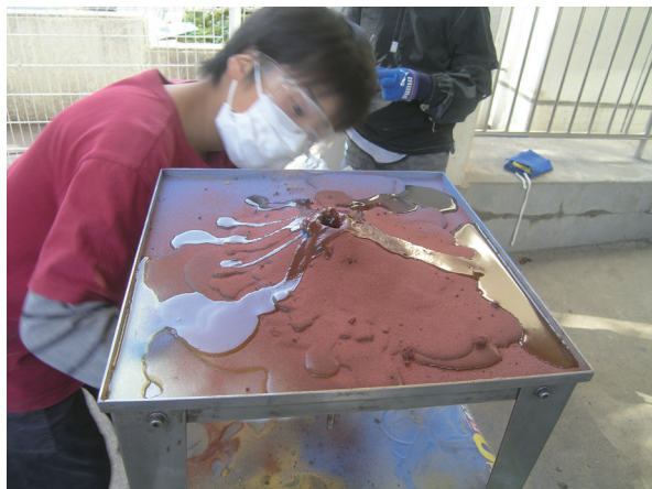
図2. 廃油実験のようす. 富士山型成層火山作製.
