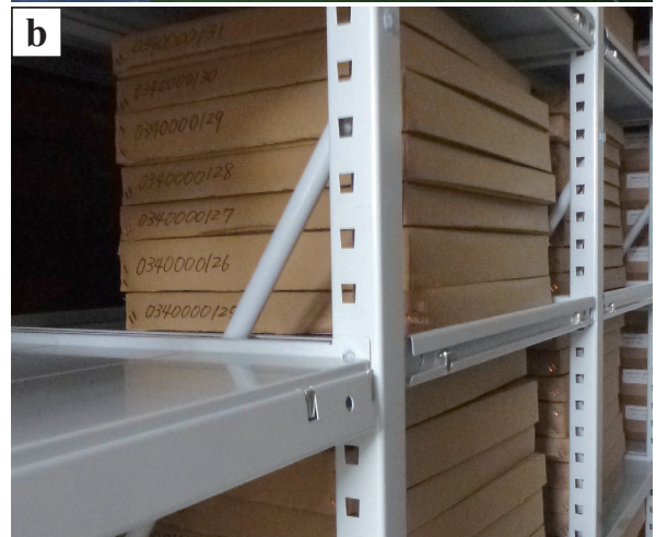
図5. 地震等で転倒しないよう、収蔵庫内の壁に紐で固定して保管する例（大阪市立自然史博物館）。
