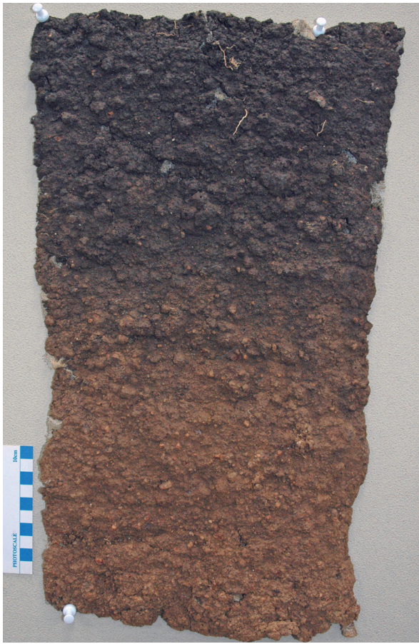
図4. クロボクと関東ローム層の境界部の剥ぎ取り標本。スケールは10 cm.
