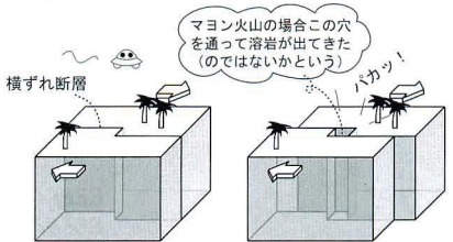
図4 プルアパートの出来方. 2つの横ずれ断層が一直線上でつながらないとき両断層の間にプルアパートと呼ばれる構造ができる。
